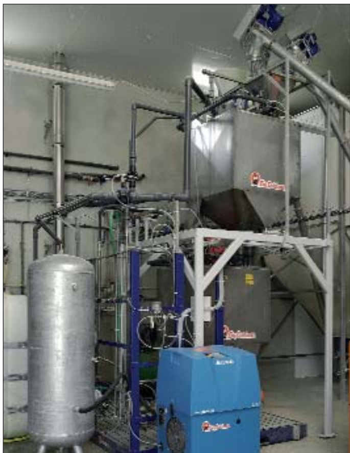
HydroAir-Synchron – tento systém s dvěma tanky umožňuje krmení velkých skupin zvířat mnoha recepturami bez dlouhých čekacích dob
