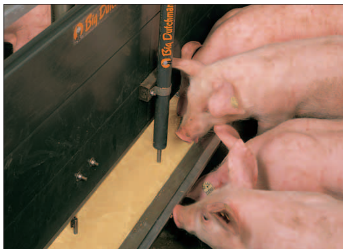
Senzor registruje stav naplnění žlabu
