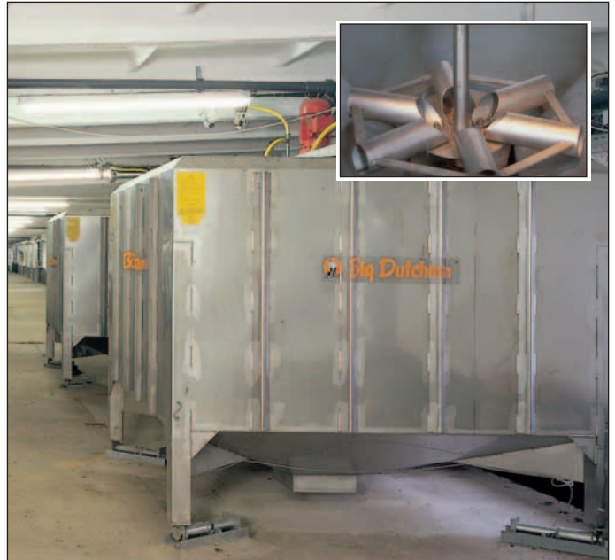
Míchací nádrž z nerezavějící ušlechtilé oceli s 4bodovým navažováním a míchadlem
